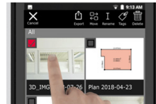
④ Utilisez le bouton « Select » pour sélectionner un objet. Différentes fonctions sont disponibles : exporter, déplacer vers projet, renommer, baliser et supprimer.
